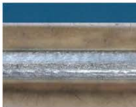
Buen cordón de soldadura sin defectos
